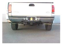
**\*\*MAKE SURE YOU HAVE A MINIMUM OF 1" CLEARANCE ON ALL PIPES FROM RUBBER BRAKE LINES, FUEL LINES, TIRES, SHOCKS, ETC..."**
