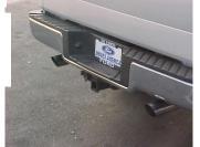
MAKE SURE YOU AT LEAST A 1" CLEARANCE ON ALL BRAKE LINES, FUEL LINES, SHOCKS, TIRES, ETC. USE ZIP TIES TO TIE THE BRAKE LINES OUT OF THE WAY.
