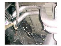
INSTALL PASS. SIDE TAILPIPE # C INTO MUFFLER 1 ½" TO 2".
