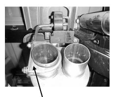
ATTACH REAR MUFFLER HANGER # F TO THE OUTLET OF THE MUFFLER ON DRIVERSIDE AND INSERT WELDED HANGER INTO GROMMET. MAKE SURE MUFFLER OUTLETS ARE LEVEL,
