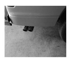
INSTALL YOUR STAINLESS TIPS. NOW TIGHTEN ALL CLAMPS AND HANGERS STARTING FROM THE MUFFLER BACK.
