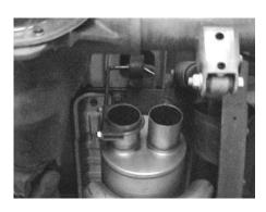
INSTALL REAR MUFFLER HANGER # F ON TO THE DRIVERSIDE MUFFLER OUTLET. SLIDE HANGER INTO RUBBER GROMMET. DO NOT TIGHTEN
