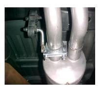
INSTALL REAR MUFFLER HANGER # I ONTO DRIVER SIDE OUTLET OF THE MUFFLER AND INSERT THE WELDED HANGER INTO RUBBER GROMMET.
